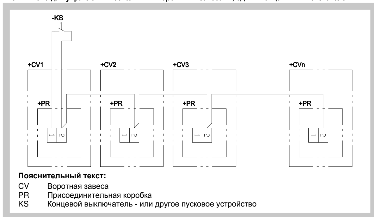
Рис. 7. Схема для управления несколькими воротными завесами, одним концевым выключателем
